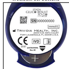
Drehen Sie das Messgerät um, sodass Sie das Etikett sehen. Das Symbol zeigt auf das Batteriefach. Ziehen Sie das Batteriefach ganz heraus, sodass die Batterie freiliegt. Ersetzen Sie die Batterie.
